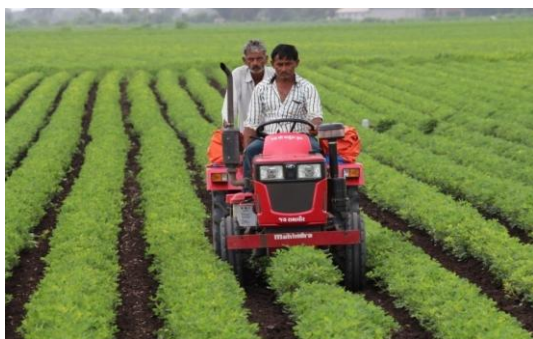
चित्र सं.1 मूँगफली में मिनी ट्रेक्टर (बायें) तथा बेलों (दायें) द्वारा चालित ब्लेड हेरो से अन्तःसस्य क्रिया।
